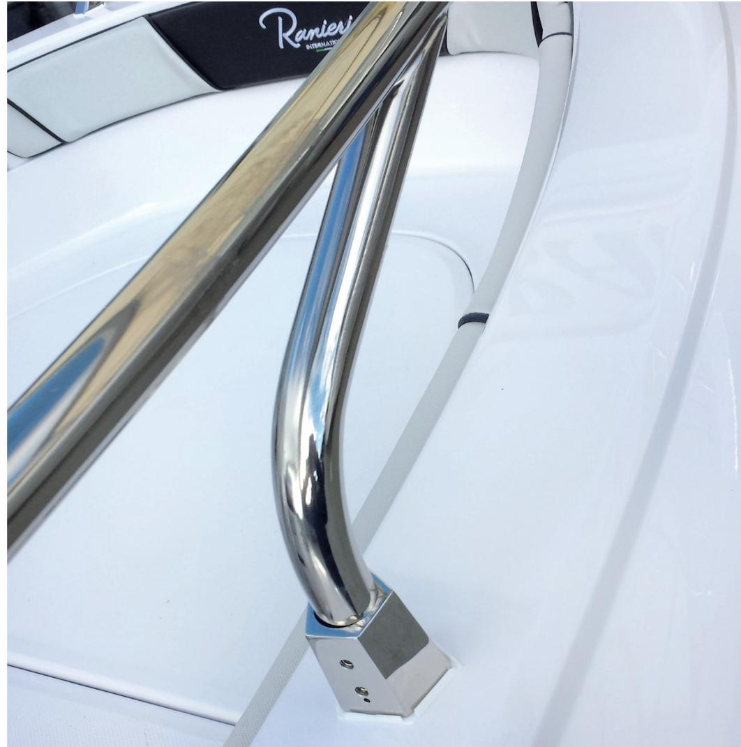
Le corrimanie, battagliole o spalliere, sono oggetti di primaria importanza all'interno di una imbarcazione; conferiscono un grande valore estetico nonché funzionale e protettivo per l'utente. Realizzati tramite progetto o per mezzo di dime in resina. Si procede quindi alla realizzazione del primo prototipo sottoposto ad approvazione del cliente, si avvia dunque la produzione seriale.
