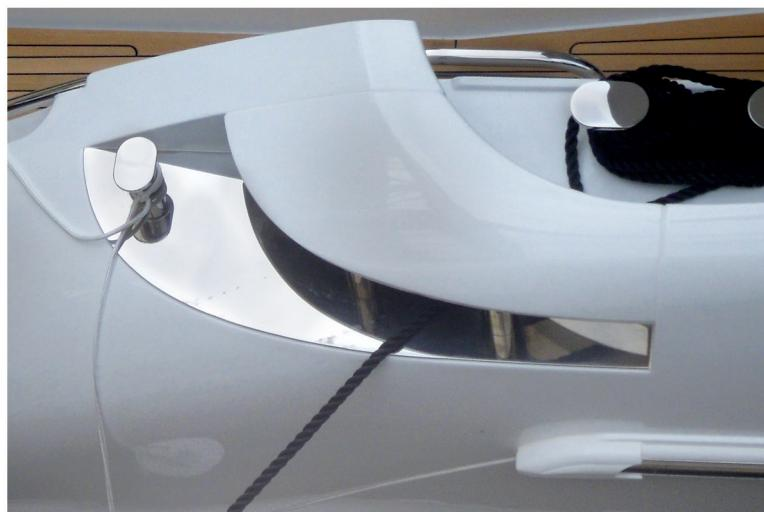
Alcune lavorazioni accessorie che è possibile eseguire. Si spazia dalle scritte poppiere nei materiali più diversi agli scudi paracolpi per ancore in acciaio sagomati sulle prue delle imbarcazioni. Maniglie e corrimano per interni ed esterni realizzati in ogni sezione di tubolare. Invece i materiali plastici impiegati per oggettistica d'arredo interno, quali portabicchieri, vetrinette, espositori per bottiglie, sono solo alcune delle realizzazioni dell'azienda.
