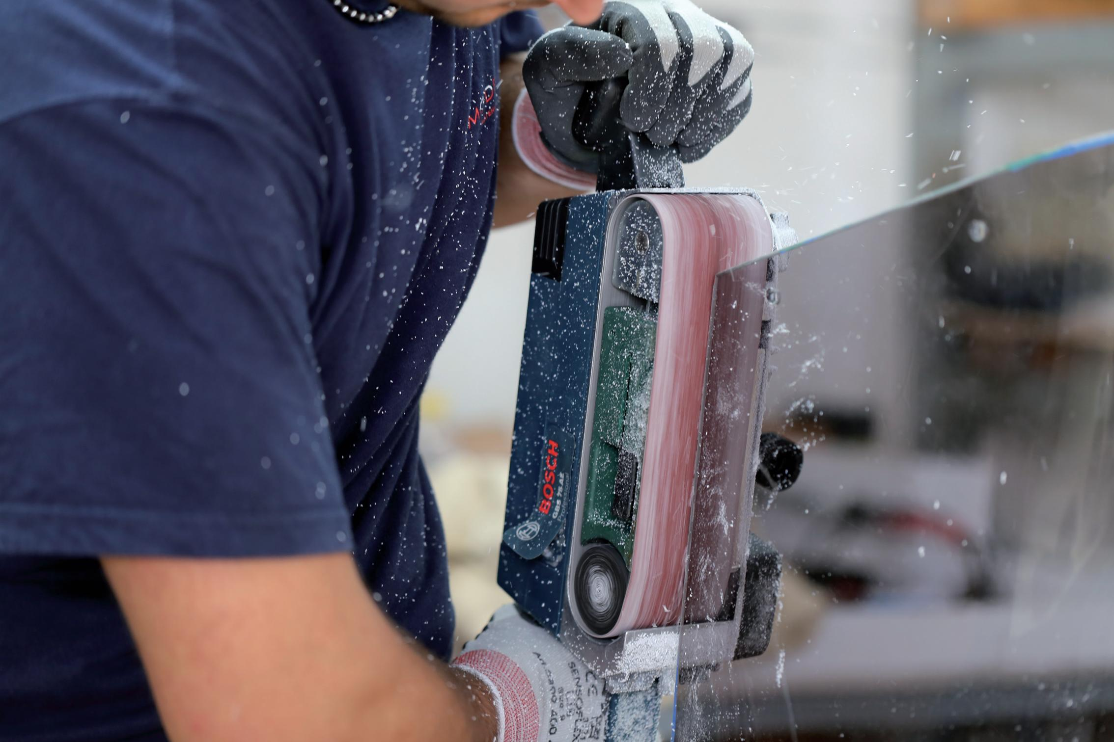
Le immagini si riferiscono alle fasi di termoformatura del plexiglas realizzate all'interno di forni dedicati. I processi successivi sono: la sgrossatura del materiale da portare alla forma desiderata, la lucidatura superficiale e perimetrale ed infine il controllo visivo e formale del prodotto finito. Su richiesta dei clienti si realizzano strutture in plexiglas ed acciaio assolutamente fuori standard con forme e soluzioni che il mercato della produzione seriale non potrà mai fornire.
